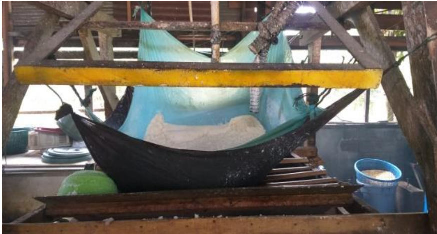
Gambar 6. Penyaringan bubur kedelai
