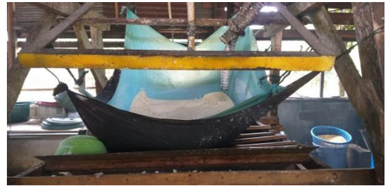
Gambar 4. Penyaringan Bubur Kedelai
