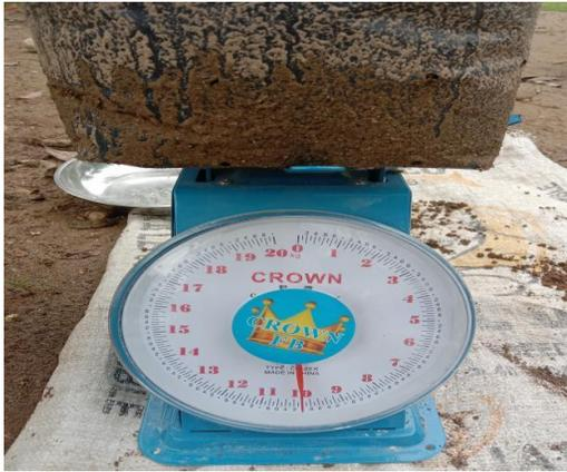
Gambar 7. Penimbangan tanah aluvial
