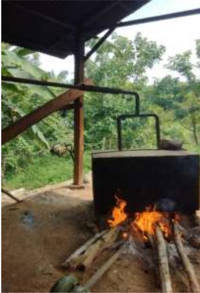
Gambar 1. Tungku Tempat Perebusan Sistem Uap
