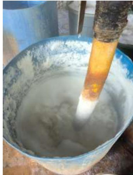
Gambar 2. Perebusan Sistem Uap
