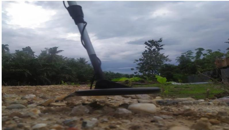
Gambar 5.17 Pengujian Sensor Jarak 20 cm
