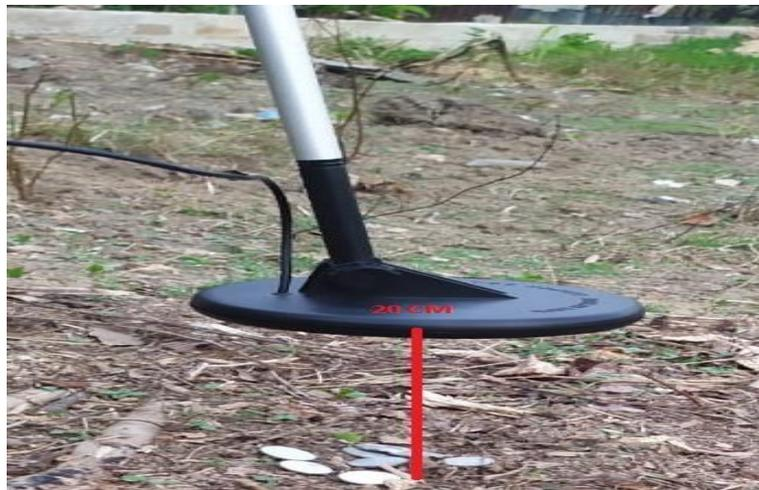
Gambar 5.9 Pengujian Sensor Jarak 20 cm
