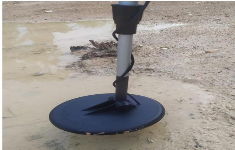
Gambar 5.23 Pengujian Sensor Jarak 15 cm
