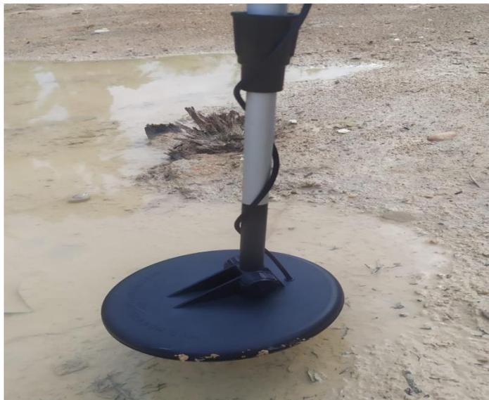
Gambar 5.19 Pengujian Sensor Jarak 5 cm
