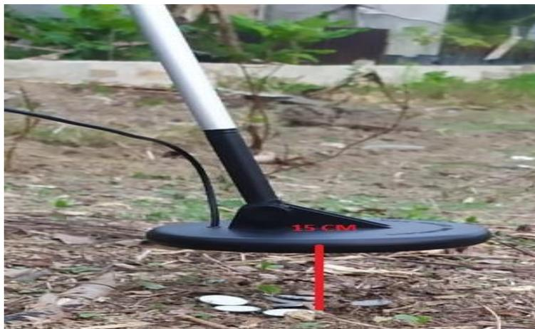
Gambar 5.7 Pengujian Sensor Jarak 15 cm
