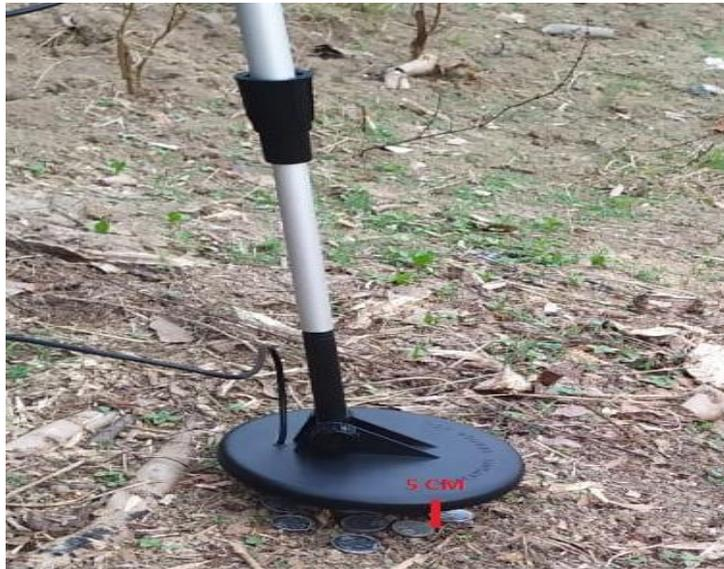
Gambar 5.3 Pengujian Sensor Jarak 5 cm
