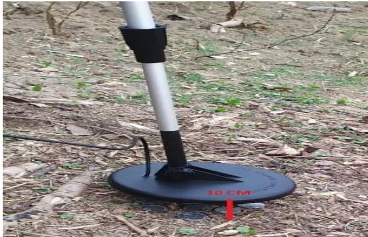
Gambar 5.5 Pengujian Sensor Jarak 10 cm
