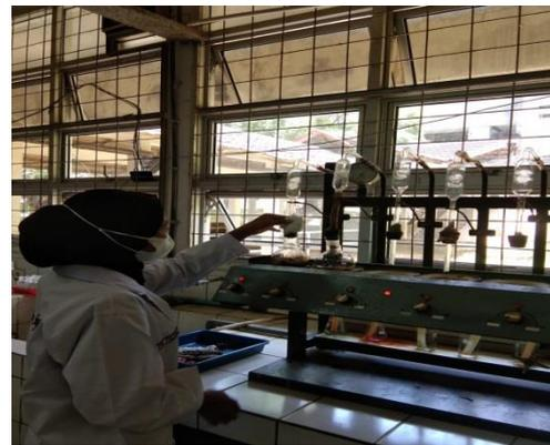
Gambar 22. Alat Destilasi Untuk Menganalisis N-total Metode Kjeldahl
