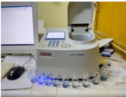
Gambar 23. Spektrofotometer, Pengukur P-total.
