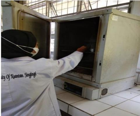
Gambar 19. Proses Pengovenan Untuk Pengeringan Sampel
