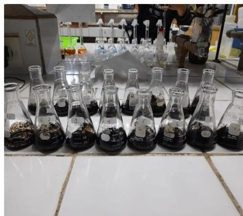
Gambar 18. Sampel 0,25g di+H<sub>2</sub>SO<sub>4</sub> 2,5 ml Diamkan Satu Malam.
