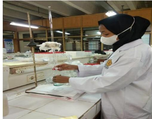
Gambar 20. Proses Titrasi Untuk Menentukan Kadar N.
