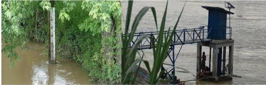
Gambar 2.2. Alat ukur tinggi muka air manual (papan duga air) dan otomatis (AWLR)
