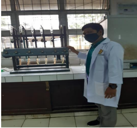
Gambar 13. Pengukuran Nitrogen dengan Metode Kjedahl
