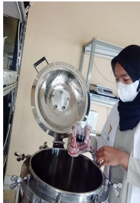
Mengeluarkan Media Dari Autoclave
