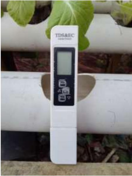
**Gambar. Alat pengukur TDS/EC**
