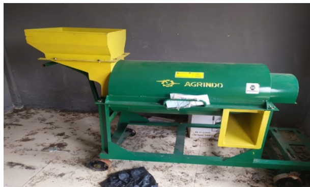
Gambar : 4.4 Mesin Pencacah Organik Dan Anorganik Sumber: Dokumentasi pribadi, 2021
