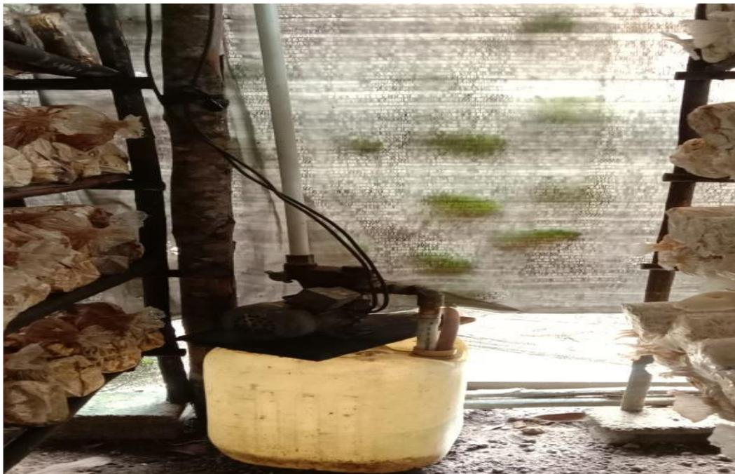
Gambar 11. Mesin Penyiram Jamur Tiram
