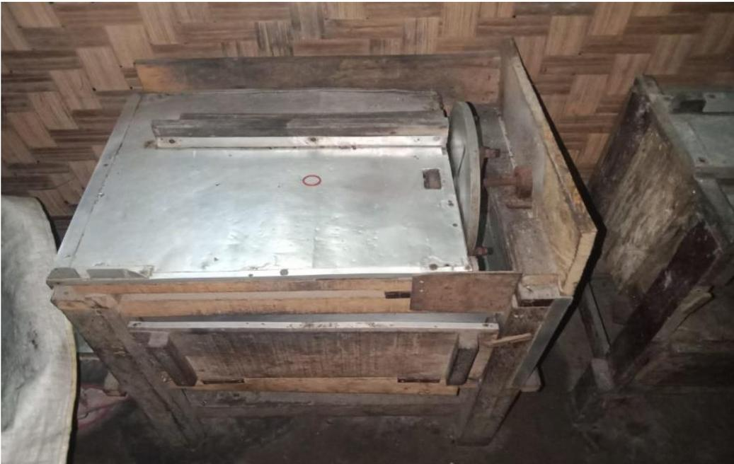
Gambar 6. Mesin pemotong kerupuk sagu
