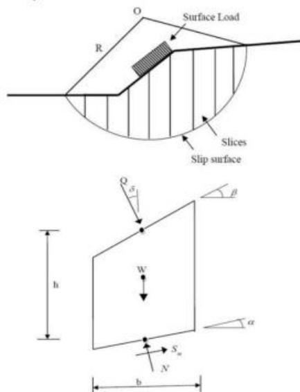
Gambar 2.1. Analisis Stabilitas Lereng dengan Metode Keseimbangan Batas
