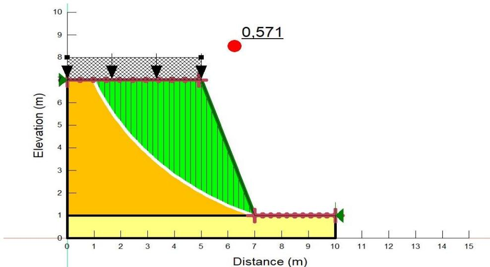
Gambar 4.7 Hasil Analisis Lereng Tanpa Perkuatan Pada Variasi Beban Vertikal
