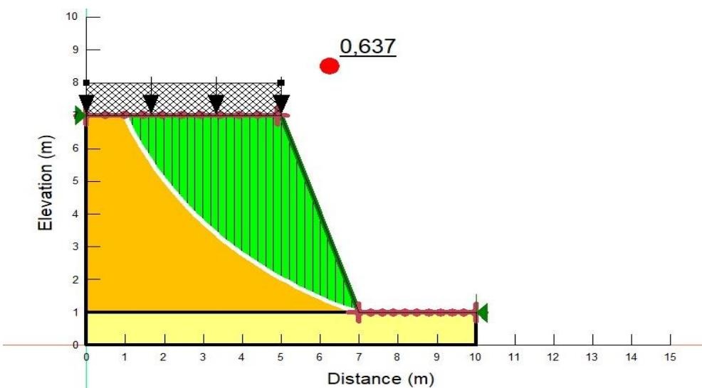
Gambar 4.6 Hasil Analisis Lereng Tanpa Perkuatan Pada Variasi Beban Vertikal
