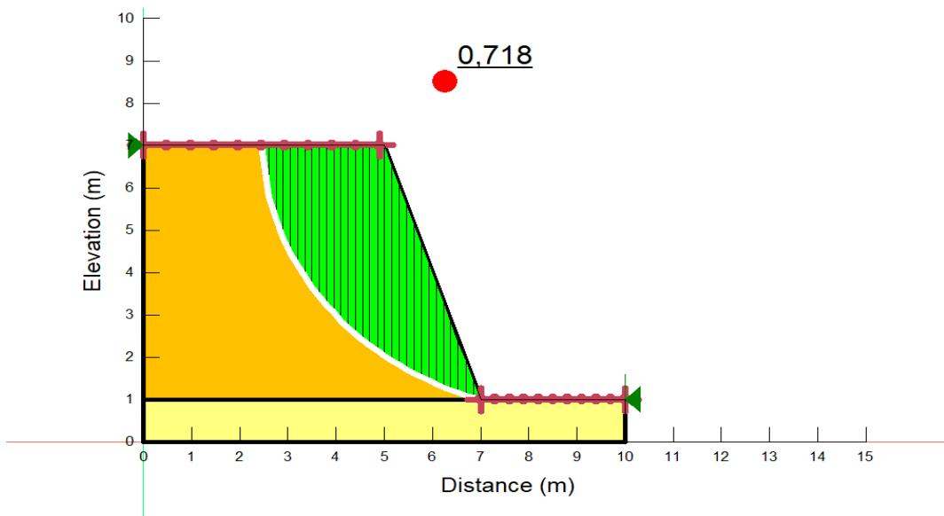
Gambar 4.3 Hasil Analisis Kelongsoran Lereng dengan Program *Geoslope*
