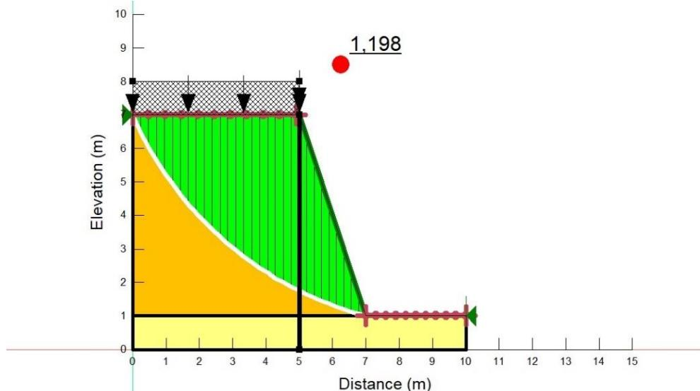
Gambar 4.11 Hasil Analisis Kelongsoran Pada Lereng Dengan Perkuatan Tiang Bor (*Bore Pile*) Variasi Beban Vertikal 2 (20 kN/m<sup>3</sup> )
