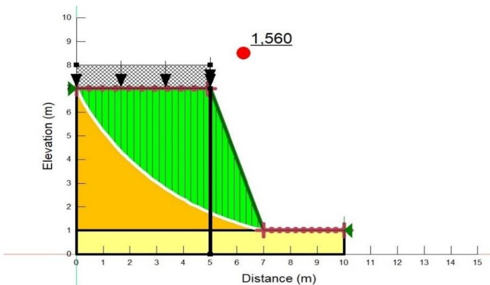
Gambar 4.10 Hasil Analisis Kelongsoran Pada Lereng Dengan Perkuatan Tiang Bor (*Bore Pile*) Variasi Beban Vertikal ( $10 \text{ kN/m}^3$ )
