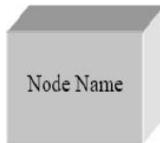
*Node* menggambarkan bagian-bagian hardware dalam sebuah sistem. Notasi untuk node digambarkan sebagai sebuah kubus 3 dimensi.
