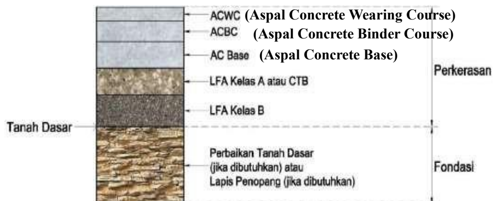
Gambar 2. 1 Struktur perkerasan lentur pada tanah asli
