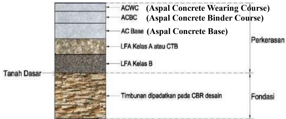
Gambar 2. 2 Struktur perkerasan lentur pada timbunan
