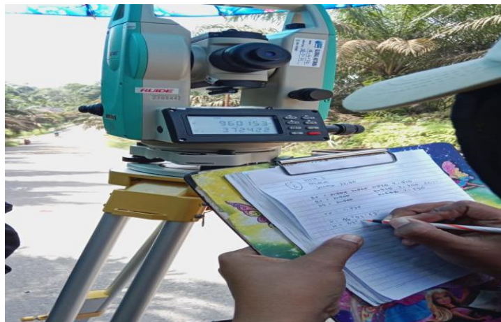
Sumber : Hasil Dokumentasi resta Yurinda (2025) Gambar D.4 Proses Pengambilan Data Lapangan Menggunakan Theodolite
