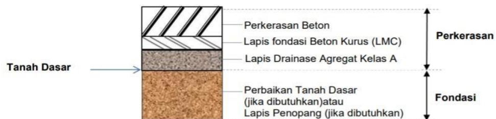
Gambar 2. 1 Tipikal struktur perkerasan kaku pada permukaan tanah asli
