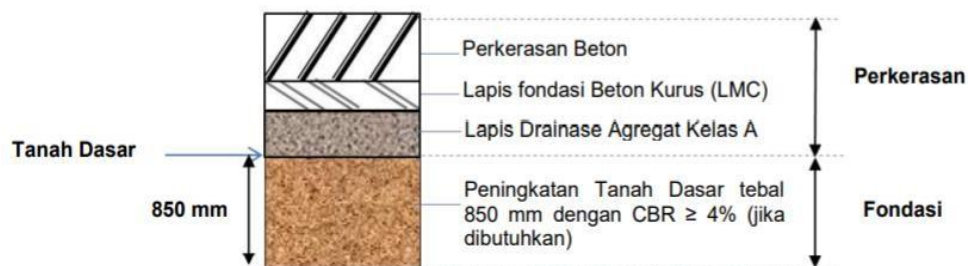
Gambar 2. 3 Tipikal struktur perkerasan kaku pada galian
