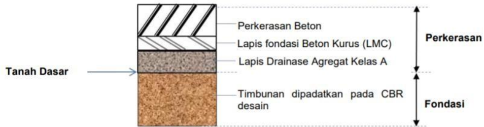
Gambar 2. 2 Tipikal struktur perkerasan kaku pada timbunan
